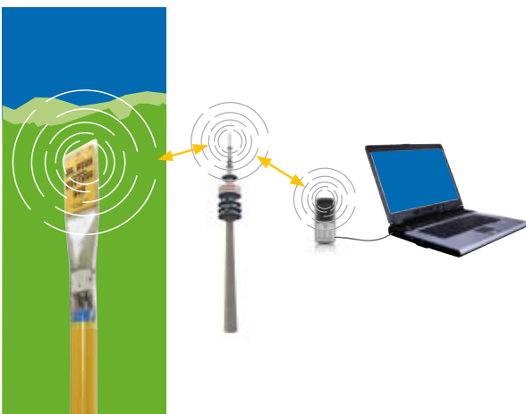
Messdatenüberwachung via GSM-Netz
